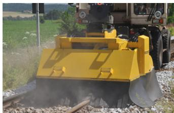
Le SKB-Ballast **sans tablier de protection** (en Scandinavie) met en évidence le fonctionnement de la brosse
