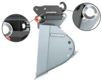
Sicher verriegelt. Anzeigestift ist eingefahren.
